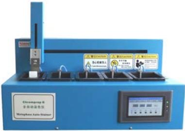
Chromprep G 自动染片机应用于染色体的显带操作。根据设定的显带方法，Chromprep G 自动染片机实现染色体显带过程中消化、中止、染色和清洗等过程的自动化操作，对胰酶消化和吉姆萨染色液染色过程中的温度和搅拌速度进行精确控制。Chromprep G 自动染片机一次可以进行24张标准载玻片的显带操作。在批量染片过程中，所有样品经过完全相同的显带过程，保证了样品处理的一致性和重复性，消除了人为操作的误差，提高染片效率，同时有助于提高染色体的制备质量，实现染色体显带的自动化和标准化。
