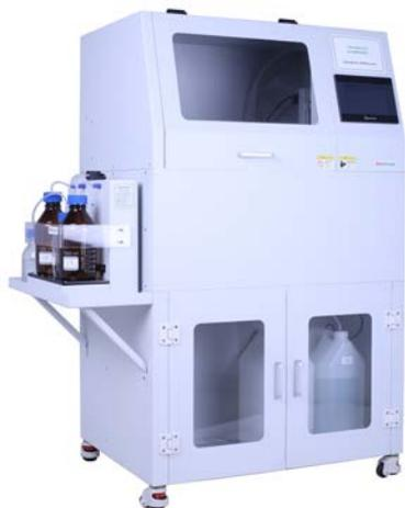
Chromprep II自动细胞收获仪是为细胞遗传学实验室专门研发的全自动染色体收获系统，能自动收获外周血、骨髓、羊水（消化法）及其它样品的中期染色体，用于核型分析。通过预先设定的程序，Chromprep II系统对细胞悬液进行离心、吸上清液、加低渗液、加固定液、振荡等操作，自动完成中期染色体的收获过程。Chromprep II系统可以确保染色体收获过程的一致性，提高细胞遗传学实验室样本处理的通量，优化收获质量，降低分析成本，提高分析效率。
