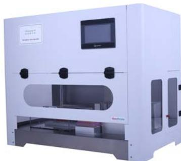
Chromprep AS 自动制片机应用于 FISH 或 G-显带核型分析，实现中期染色体（外周血淋巴细胞、骨髓细胞、羊水细胞等）滴片和染色体分散过程的自动化和标准化。通过预先设定的程序，Chromprep AS 自动制片机自动完成取载玻片、细胞样品混匀、吸细胞悬液、滴片、放载玻片等操作过程，并控制染色体分散时的温度、湿度和气流速度，实现染色体滴片过程的全自动化和标准化。Chromprep AS 自动制片机制备出的中期染色体：交叉数少、分散程度可控、重复性和一致性好。
